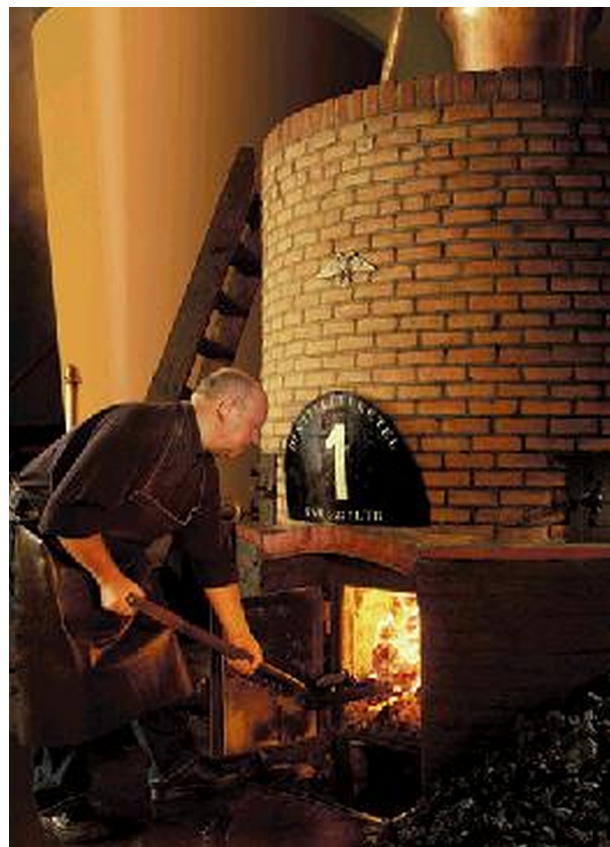
Afb. 34: opstelling van een stokerij met ronde ketel op een (half)rond fundament in Schiedam (Ketel 1 van Nolet). Bron: www.jeneverreview.nl .
